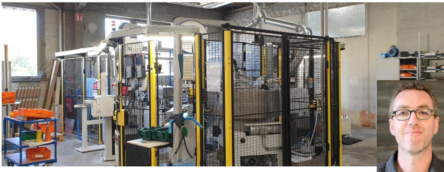
**D**epuis fin septembre notre parc machine se compose d'une 7ème unité de meulage des lames. Ce parc étant déjà composé d'une machine pour rectifier le dos des lames et de six unités de meulage développées spécifiquement pour Opinel avec notre partenaire historique basé en Allemagne.
