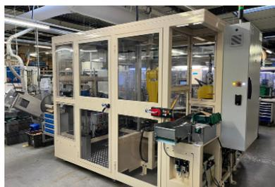
Le principe de chargement a été inspiré par celui de la ligne 6 avec deux robots qui déposent les composants dans la ligne existante.
